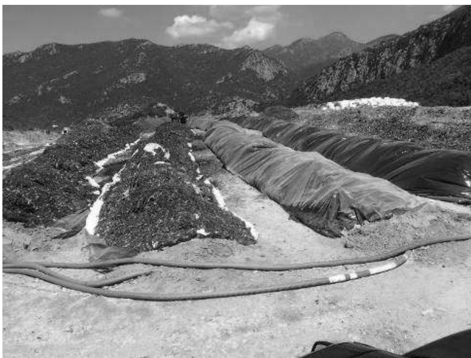
Κομποστοποίηση σε ενεργά αεριζόμενους σωρούς
